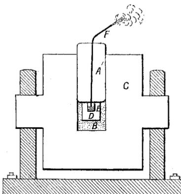
FIG. 54.—MORTAR FOR MEASURING THE BALLISTIC POWER OF EXPLOSIVES.
